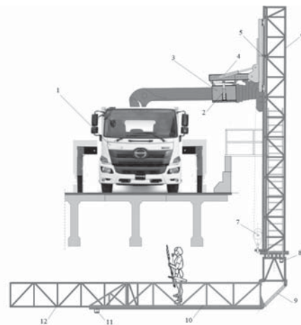
1 - Xe cơ sở; 2 - Cơ cấu giữ ổn định cho bộ công tác; 3 - Hộp kết nối; 4 - Cơ cấu dựng dàn đứng; 5 - Chốt hãm thủy lực; 6 - Dàn đứng; 7 - Móc cầu; 8 - Cơ cấu quay sàn công tác; 9 - Cơ cấu nâng hạ sàn công tác; 10 - Sàn công tác; 11 - Cơ cấu thu - đẩy sàn kéo dài; 12 - Sàn kéo dài
