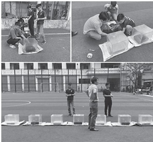
Hình 3.3: Mô hình thí nghiệm đánh giá khả năng hấp thụ khí thải của mặt đường
